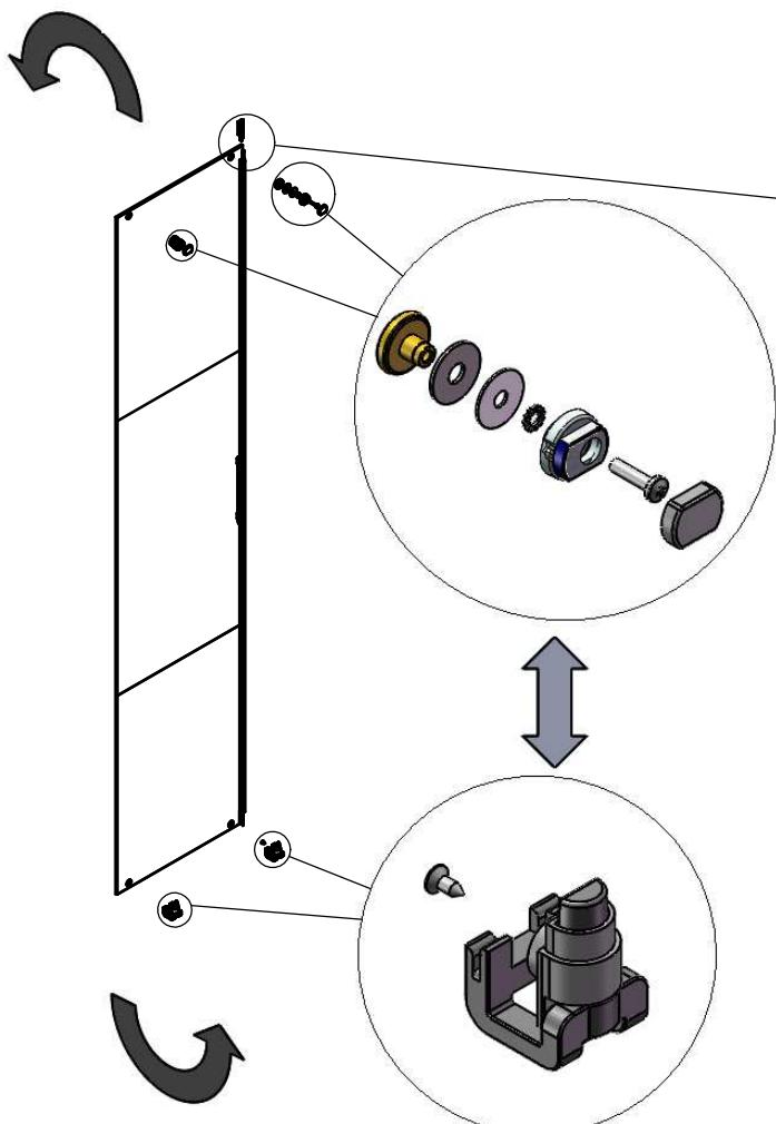
Se montata a sinistra, capovolgere l'anta, invertendo i cuscinetti inferiori con i superiori. Ruotare il magnete e bloccarlo con l'apposito tappo.
