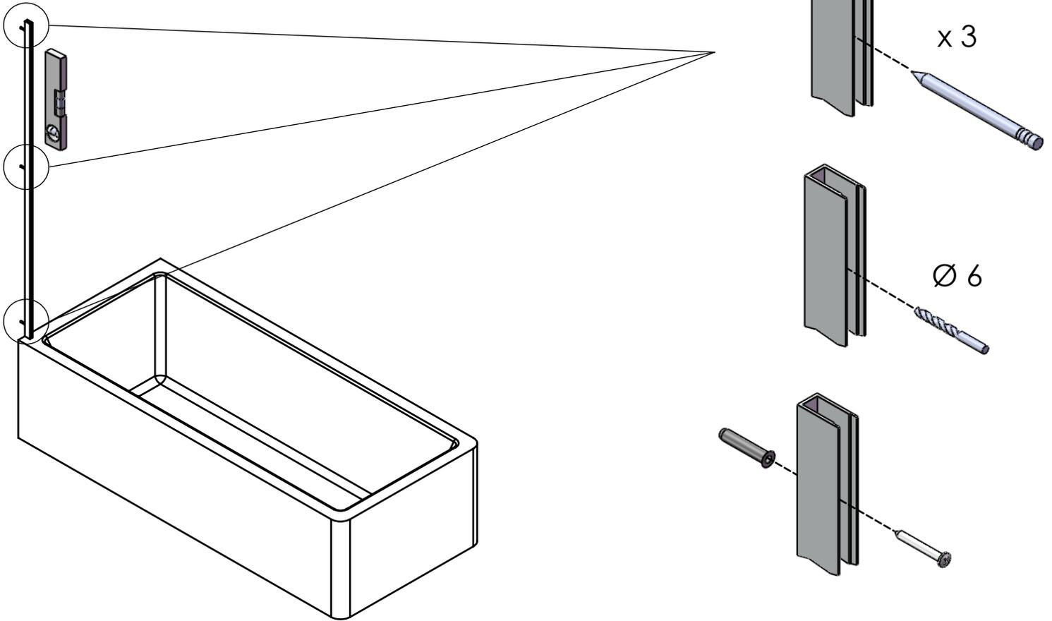
Inserimento dell'anta e fissaggio dell'attacco a muro.
