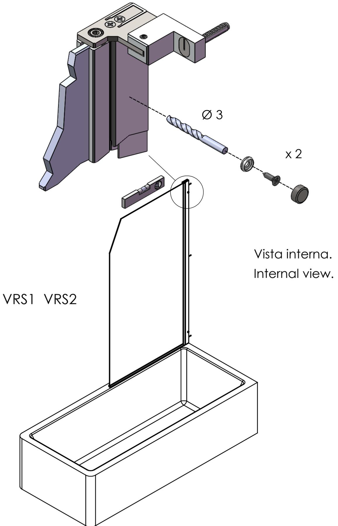
Montaggio della seconda anta.
