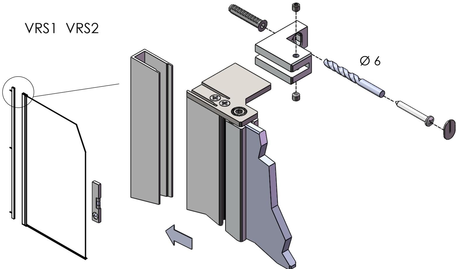
Fissaggio dell'anta al profilo a muro.
