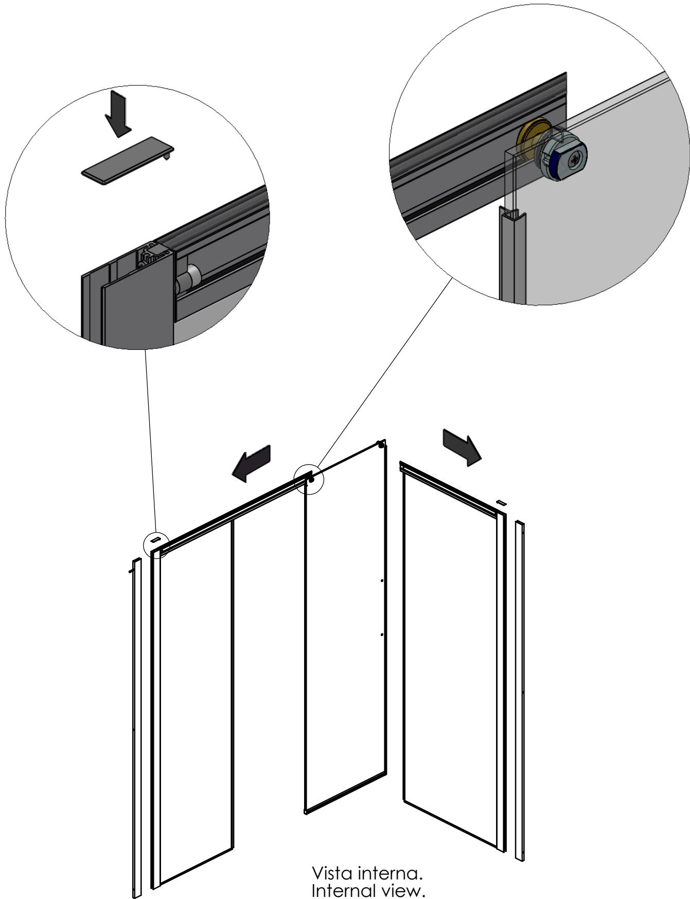
Fissaggio dei 2 lati tramite l'angolare.
